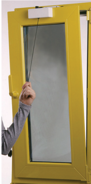
Bild 3: Kippfenster mit automatischer Schließvorrichtung. Durch Ziehen an der Kordel wird die Feder des Schließmotors gespannt. Die Öffnungszeiten können auf 5 bis 60 Minuten eingestellt werden. (Bild: Michael Wolf, TK-Plan).
