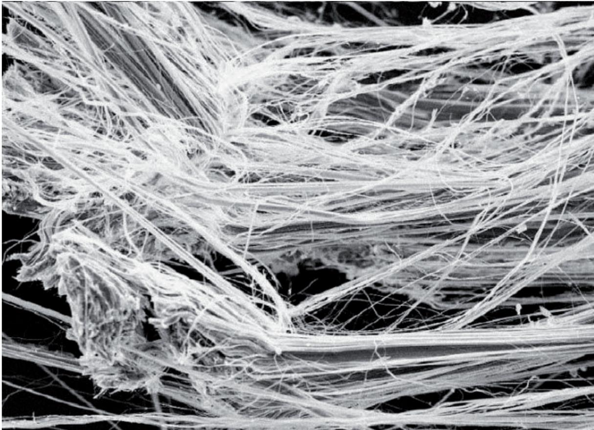
Abbildung 1: Elektronenmikroskopische Aufnahme von Asbestfasern (Quelle: Blei-Institut)
