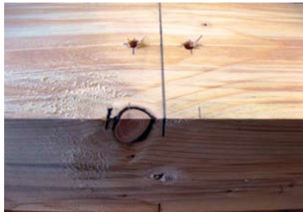
Abb. 5: Anordnung der Bohrlöcher zum Einbringen der Temperaturfühler und des infizierten Holzdübels
