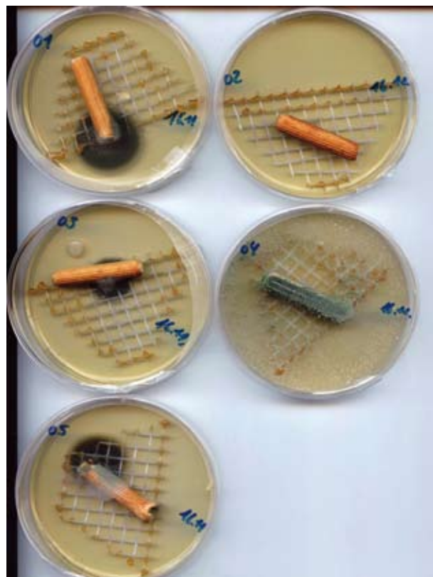
Abb. 10 a: Fremdinfecte (Schimmelpilze) an Buchendübeln, die in einem mit Alufolie ummantelten Holz im Trockenschrank bei 65 °C für 90 min exponiert wurden
