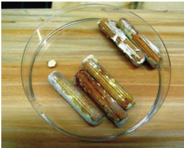
Abb. 4: Mit dem Schmetterlingsporling bewachsene Buchenholzdübel
