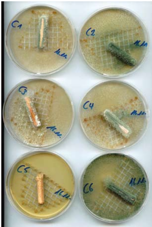
Abb. 10 b: Fremdinfekte (Schimmelpilze) an Buchendübeln, die sich in dem Holz befanden, welches über Heizkabel thermisch behandelt wurde
