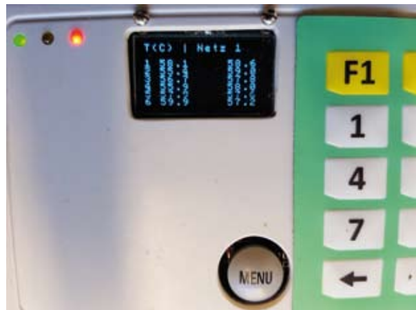
Abb. 7: Holzinnentemperatur an den 12 Messpunkten nach ca. zwei Stunden
