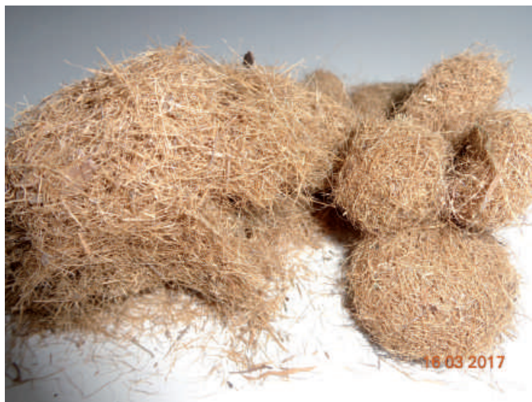
Abb. 1: Seegrass als Dämmstoff aus dem Mittelmeergebiet (Quelle: Blei-Institut)
