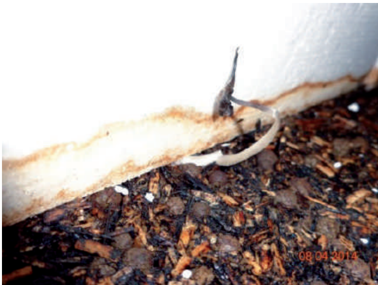
Abb. 5: Tintlingsbefall ( Coprinus sp. ) auf bitumierten Hanfschäben (Quelle: Blei-Institut)
