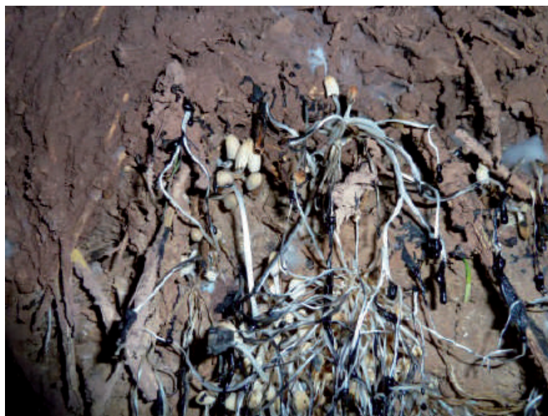
Abb. 7: Schimmelpilz- und Tintlingsbefall ( Coprinus sp.) auf Lehm (Quelle: Blei-Institut)
