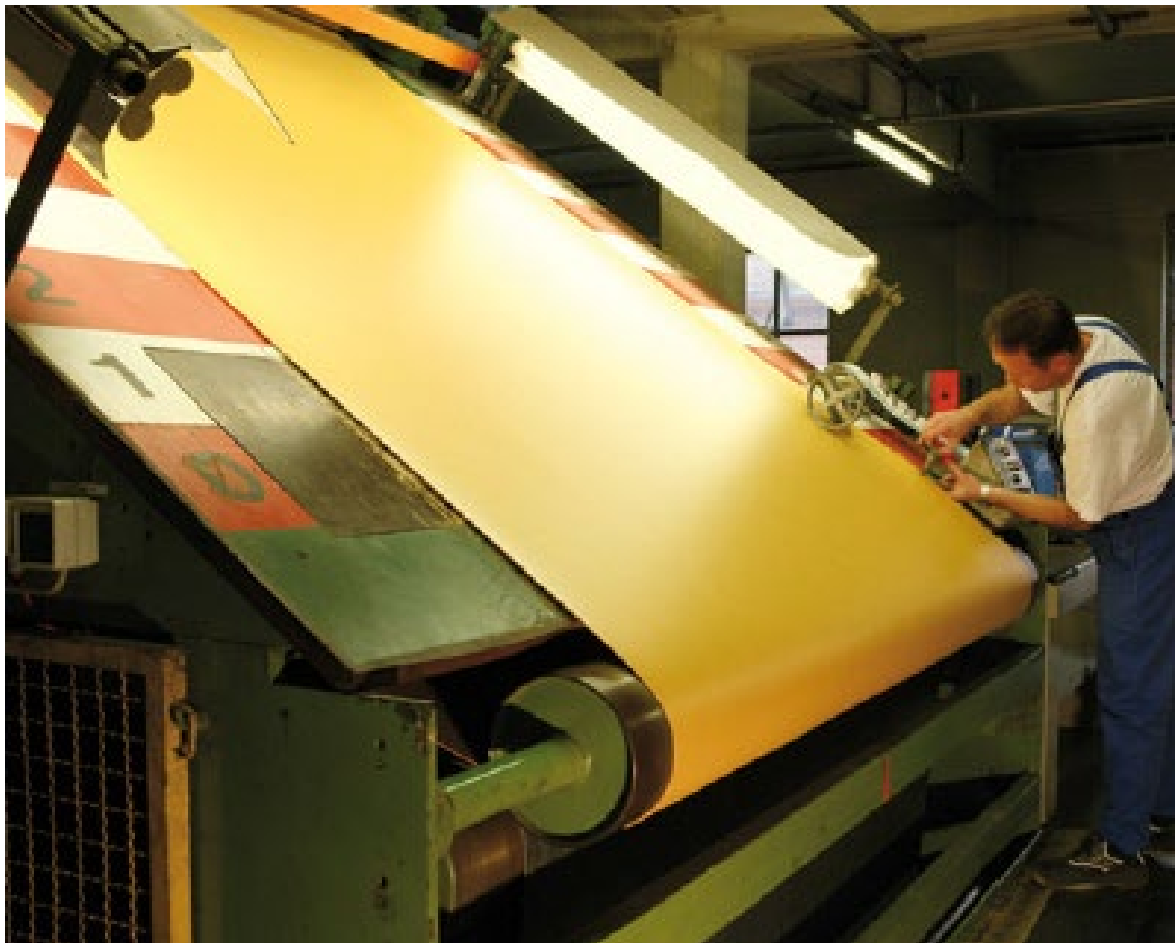
Abb. 4: Sichtkontrolle der Warenbahn (Quelle: www.baunetzwissen.de )
