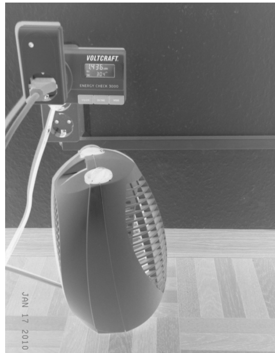
Bild 4.5: Lüfter, Energiezähler und Funkschalter
