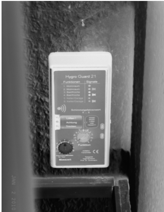
Bild 4.4: Hygro Gard zur Messung der Wandfeuchte und Lüftersteuerung
